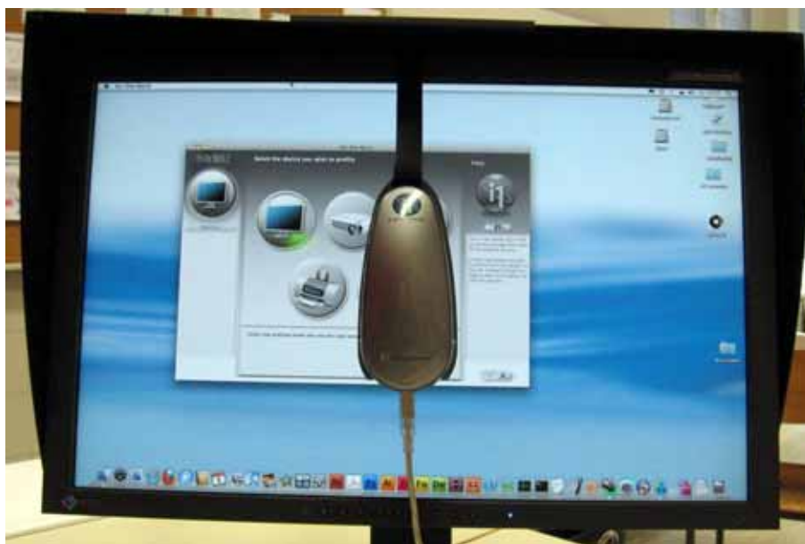
Slika 46: Priklučitev naprave za merjenje barv Eye-One ali Eye-One Display (vir: Molek, I. za Učno gradivo).
