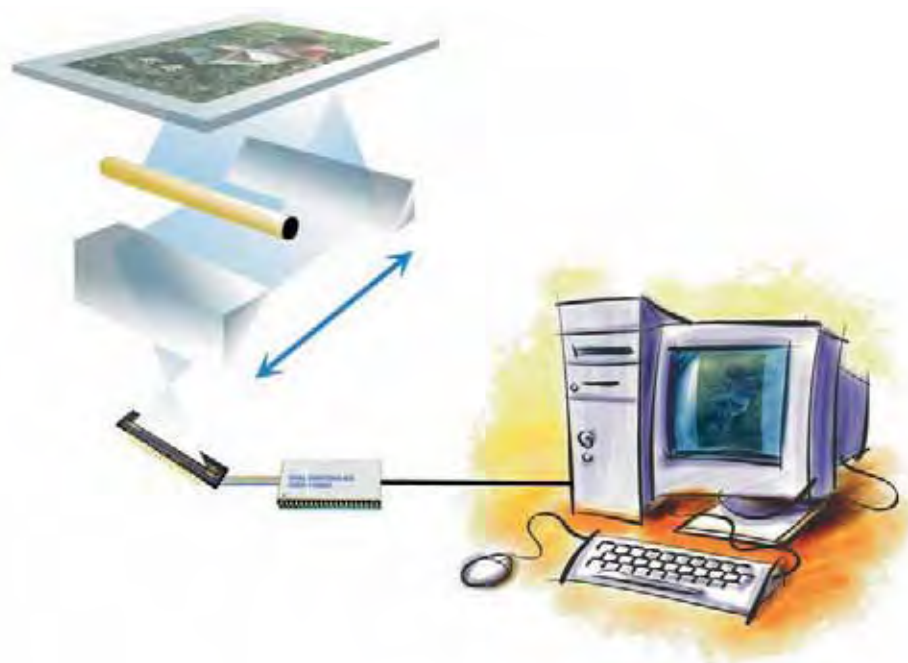
Slika 7.18 Ploski skenerji digitalizirajo predlogo z linearnim vrstičnim vezjem, ki hkrati s svetilko potuje vzdolž predloge. Svetlobni vir v svetilki je zelo natančna fluorescenčna žarnica s hladno svetlobo, tako da ne pride do segrevanja. Osvetljena slika se skozi optični sistem projicira na vrstično vezje, ki ga premika koračni pogon; pri vsakem koraku se posname in v piksele pretvori ena linija slike. Ko program v računalniku eno za drugo sestavi vse skenirane vrste, lahko na monitorju upodobi in v spomin shrani celo sliko.
