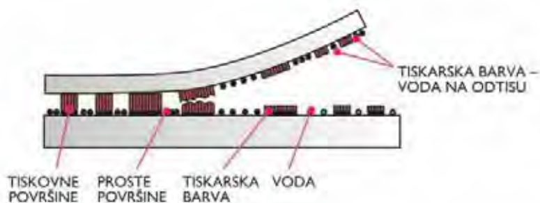
Slika 6.25 Mehanizem mokrega ploskega tiska.
