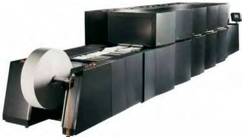
Slika 8.60 Visokozmogljiva rotacija za kapljični tisk, ki je namenjena za tisk časopisov.
