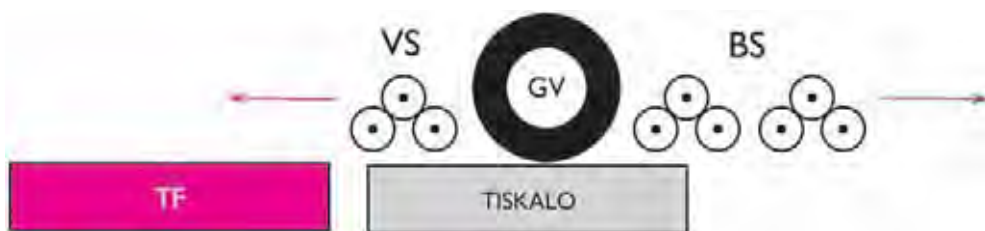
Slika 8.43 Blokovna shema ofsetne odtisovalnice.
