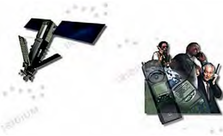
Slika 1.4 Prvi tržno dostopni mobilni telefonski aparat za globalno (satelitsko) komuniciranje so bili prirejeni za komuniciranje prek nizkoorbitalnega satelita (LEO) Iridium . Satelitski sistem Iridium je bil kot prvi operativen oktobra 1998, kasneje pa je razvoj zaradi uspešnejše mobilne telefonije zastal.
