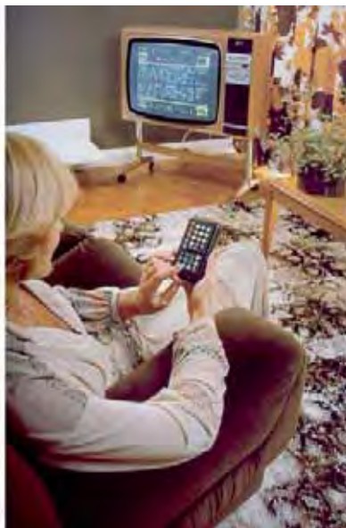
Slika 1.32 Na začetku osemdesetih let je imel teletekst še različna tržna imena, televizijske sprejemnike pa smo morali za sprejemanje dograditi z dekodirjem za videotekst, spominom kodiranih signalov in spominom črkovnega nabora. S temi in s še bolj izpopolnjenimi napravami za sprejemanje in preurejanje signalov teleteksta je dandanes standardno opremljen vsak televizijski sprejemnik.
