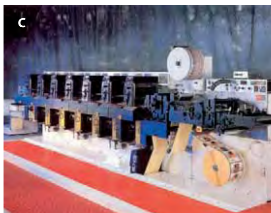
Slika 8.22 Fleksotiskarske rotacije s posamičnimi tiskovnimi členi v enem tiskovnem stolpu (A), s centralnim tiskovnim valjem po satelitnem načelu (B) in z zaporednimi tiskovnimi členi v tandemu (C). Najbolj vsestranske in prilagodljive so rotacije z zaporednimi tiskovnimi členi, predvsem zato, ker nanje lahko preprosto namestimo dodatne naprave: tiskovne člene za digitalni, slepi in vroči tisk, oplemenitenje (lakiranje), UV- in IR-sušilnike, lasersko izrezovanje in tiskanje numeričnih kod (EAN, RFID).
