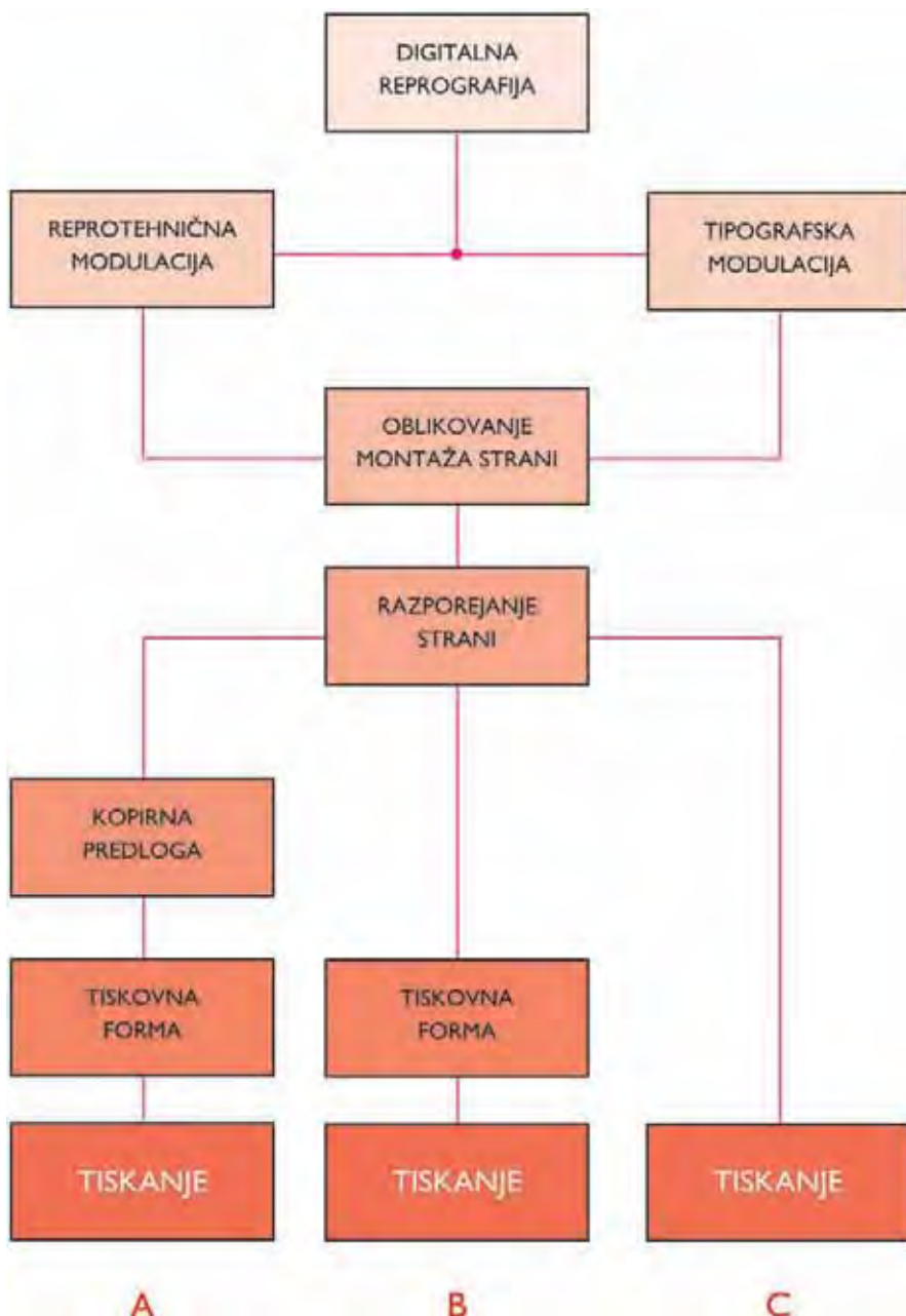
Slika 10.26 Blokovna shema digitalnega reprografskega procesa z izvedenkami. Izvedenka A – je pravzaprav hibridni proces, ker s formatno kopirno predlogo tiskovno formo izdelamo s klasičnim kemigrafskim procesom. Pri izvedenki B – jo izdelamo neposredno z digitalnim kopiranjem ali neposrednim digitalnim upodabljanjem (glej poglavje 8.5 Stroji za ofsetni tisk), pri C – pa tudi to ni potrebno, ker uporabimo eno od digitalnih tiskarskih tehnik.
