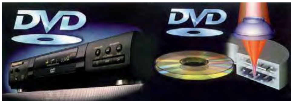
Slika 1.30 Ustroj enostransko oslojene, dvoslojne optične plošče DVD s hišnim predvajalnikom (za glasbo in filme).
