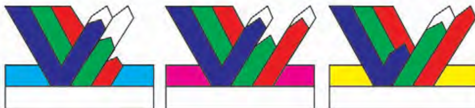
Slika 7.42 Selektivna absorpcija primarnih tiskarskih barv.
