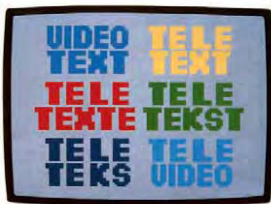
Slika 1.32 Na začetku osemdesetih let je imel teletekst še različna tržna imena, televizijske sprejemnike pa smo morali za sprejemanje dograditi z dekodirjem za videotekst, spominom kodiranih signalov in spominom črkovnega nabora. S temi in s še bolj izpopolnjenimi napravami za sprejemanje in preurejanje signalov teleteksta je dandanes standardno opremljen vsak televizijski sprejemnik.
