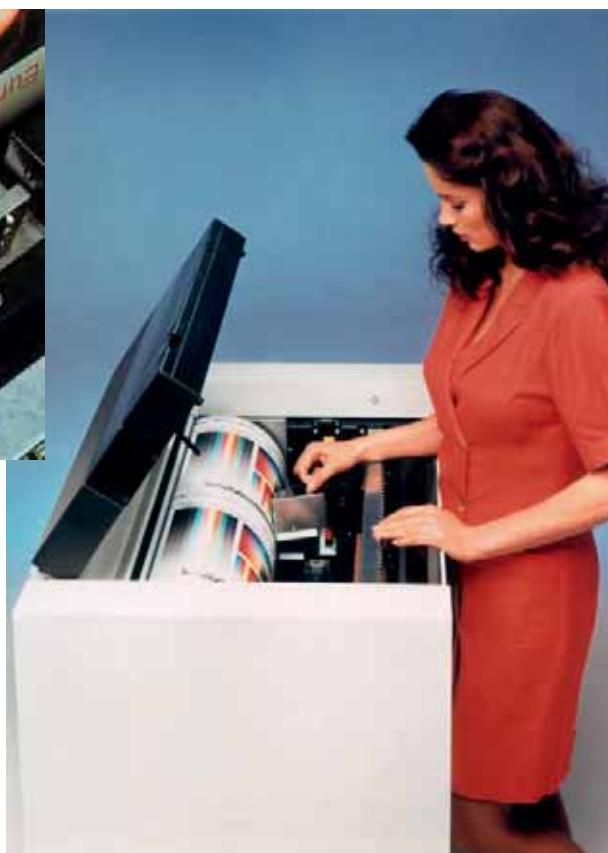
Slika 8.56 Studijski tiskarski stroj za kapljični tisk s tiskovno glavo ob tiskovnem valju, na katerega je napet tiskovni material.
