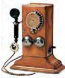
Slika 1.2 Telefonski aparat iz leta 1908 je že imel številčnico in slušalko. To je bila po prvem aparatu, ki ga je Aleksander G. Bell patentiral leta 1876 v Ameriki, vrhunska izboljšava uporabnosti in oblike.
