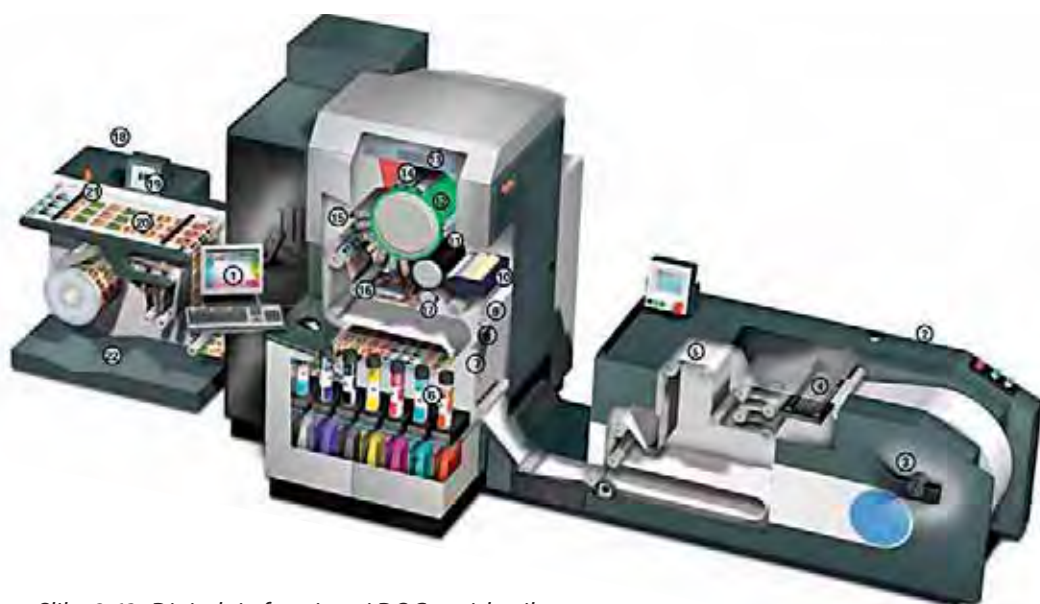
Slika 8.63 Digitalni ofsetni stroj DOC za tisk etiket.
