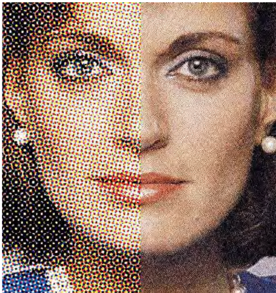
Slika 7.54 Povečava amplitudno (levo) in frekvenčno (desno) modularne rastrske strukture. Na levi so dobro vidne rozete rastrskih pik, ki jih tvorijo zasukane rastrske strukture, na desni zgolj redkejše in gostejše rastrske točke, ki se prilagajajo tudi vsebini slike. Bistveno boljše je upodabljanje podrobnosti; glej oči.
