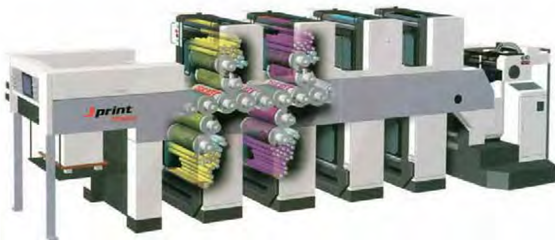
Slika 8.40 Osembarvni stroj za obojestranski tisk 4 +4 brez obračalnih bobnov je perfektor. To so specialni stroji, ki so namenjeni zlasti za gospodaren tisk knjig in akcidenčnih (priložnostnih) tiskovin.
