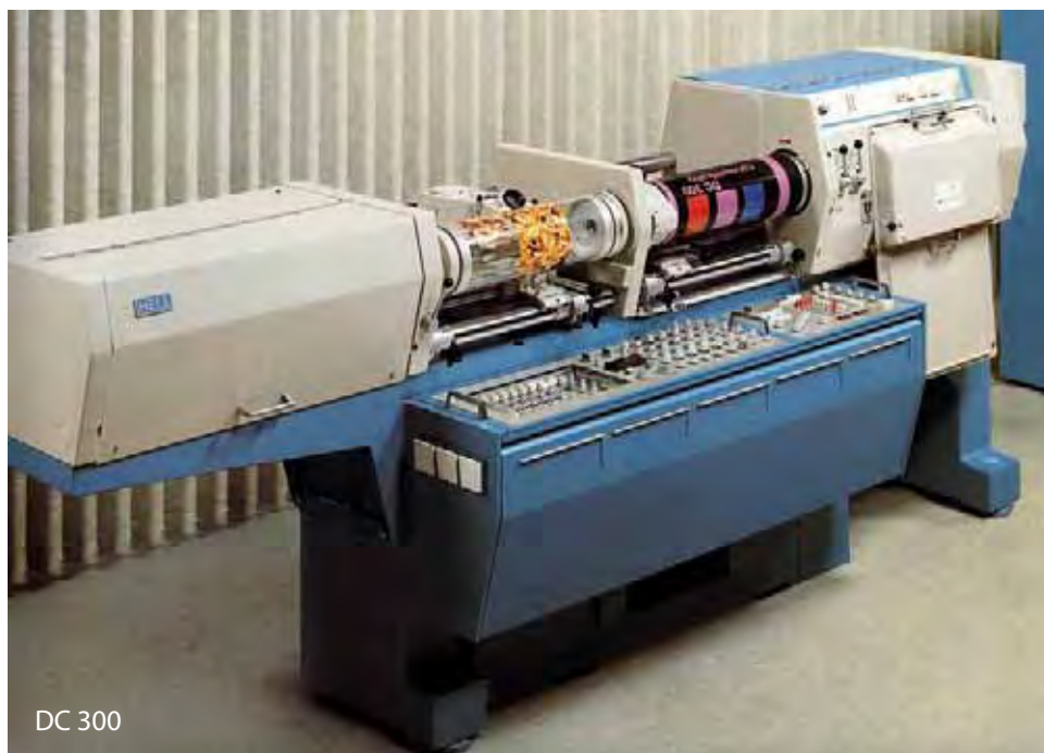
Slika 7.46 Analogno skeniranje z bobnastim skenerjem. Analogni signal, ki nastane v določenem kanalu, potuje prek ojačevalnika in modulatorja do žarnice; ta zasveti premo sorazmerno z jakostjo signala in na fotomaterialu osvetli ustrezno slikovno točko. Snemalna in slikovna (upodobitvena) enota analognega skenerja sta praviloma komponenti ene naprave in fizično nista ločeni. Najboljši in najimenoitnejši analogni skener vseh časov je bil Helov DC 300
