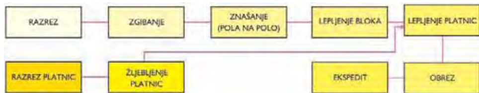
Slika 9.52 Dodelava lepljene brošure po slikah 110 D oziroma 111A. Knjigoveška linija za tak proces je prikazana na sliki 9.55.
