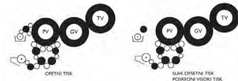
Slika 8.26 Tiskovni člen ofsetnega stroja pri tiskanju v ofsetnem tisku, suhem ofsetnem tisku in posrednem visokem tisku.
