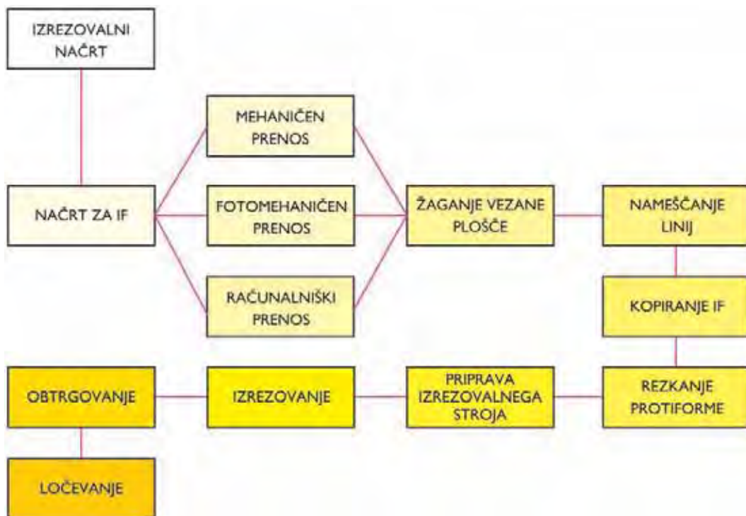
Slika 9.23 Blokovna shema tehnološkega procesa za izdelavo izrezovalne ali žlebilne forme za izrezovanje na izrezovalnem stroju.
