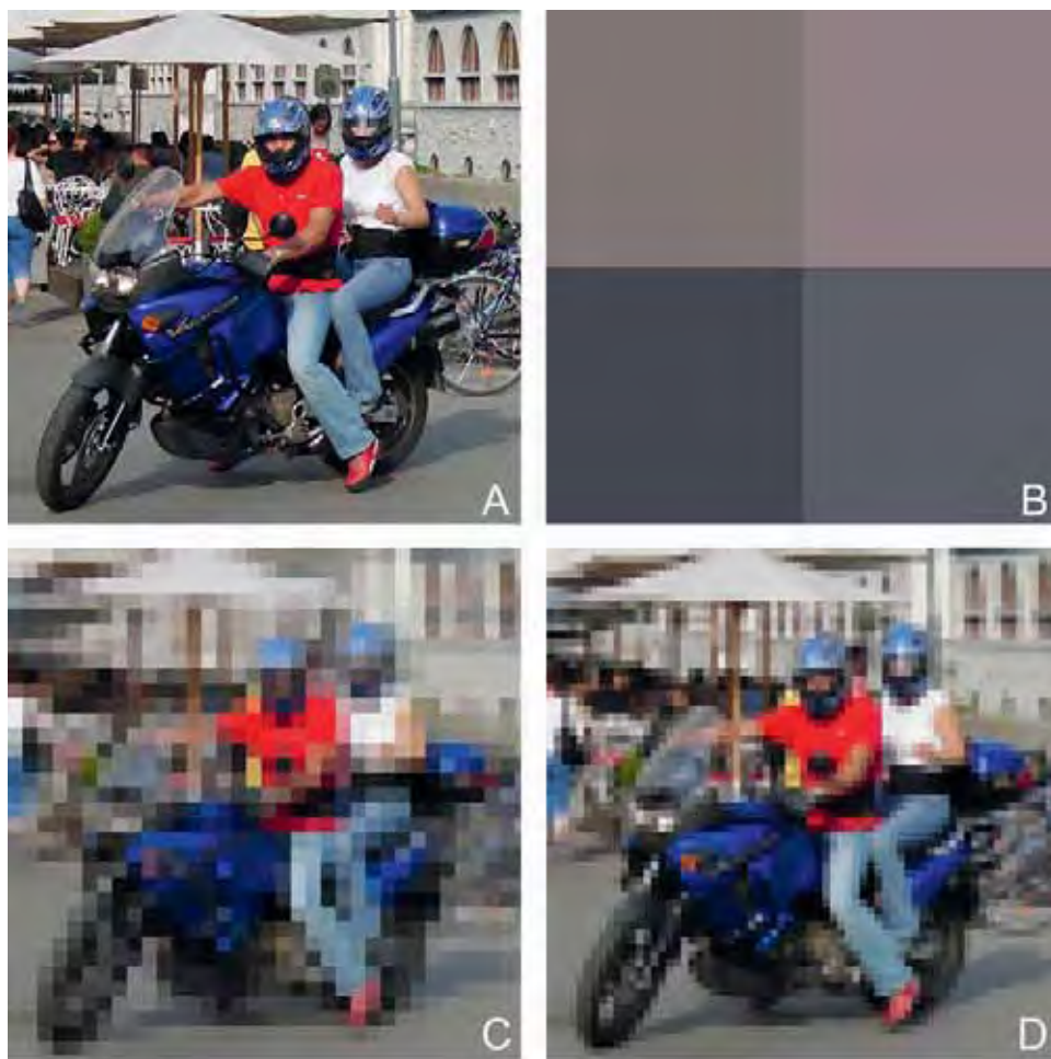
Slika 7.13 A) Čeprav je reprodukcija digitalna, upodablja navidezno oz. fotografsko real- nost. Opazovalec prepozna vso njeno vsebino, realne barvne učinke, podrobnosti in ostrino. B) V tem primeru je slika (A) digitalizirana samo s štirimi piksli. Četudi imajo 24-bitno barvno globino, dobimo nerealno upodobitev, opazovalec pa ne more prepoznati njene sporočilne
