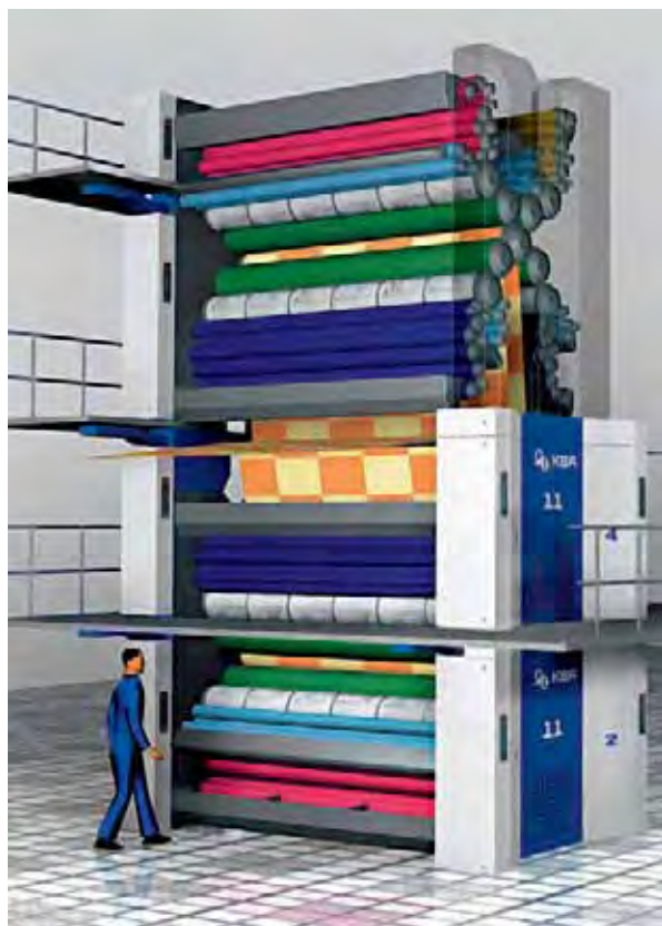
Slika 8.42 Klasična časopisna rotacija ima tiskovne člene razporejene v enem ali več tiskovnih stolpih po satelitem načelu, tj. s centralnim tiskovnim valjem.
