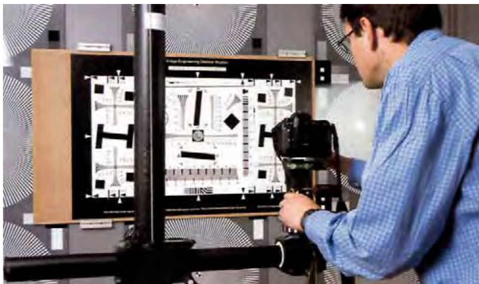
Slika 7.16 Preskušanje digitalne kamere v laboratoriju. Z opisanimi preskusi so na primer ugotovili, da večina klasičnih, analognih objektivov ni primerna za digitalno fotografijo z zrcalnorefleksnimi kamerami. Do tega prihaja zlasti zato:
