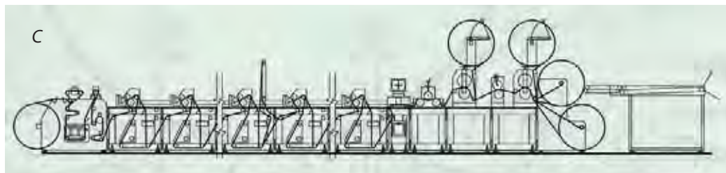
Slika 8.21 Shematični prikaz fleksotiskarskih rotacij s posamičnimi tiskovnimi členi v enem tiskovnem stolpu (A), s centralnim tiskovnim valjem po satelitnem načelu (B) in z zaporednimi tiskovnimi členi v tandemu (C).
