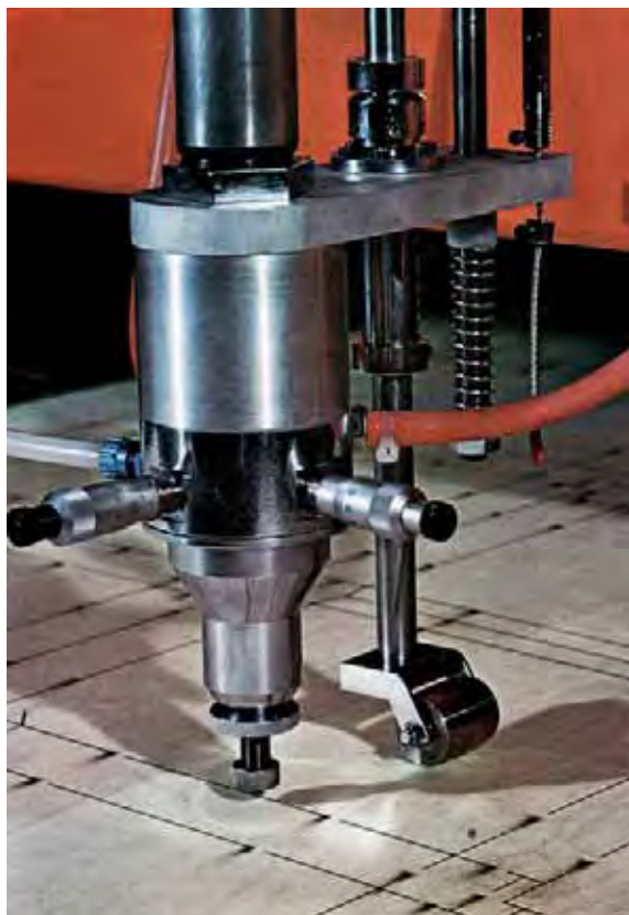
Slika 9.26 B Žaganje kanalov za izrezovalne in žlebilne linije z laserskim žarkom CO 2 . Izrezovalna glava je nad trdno vpeto vezano ploščo računalniško vodena, kar zagotavlja izjemno natančnost.
