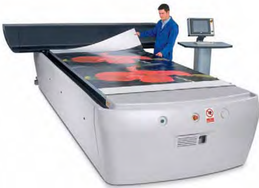
Slika 8.59 Nekateri stroji za velikoformatni kapljični tisk spominjajo na ofsetne odtisovalnice, saj imajo tiskovne glave nameščene v gibajočem se vozičku, medtem ko tiskovni material miruje na tiskovni plošči.
