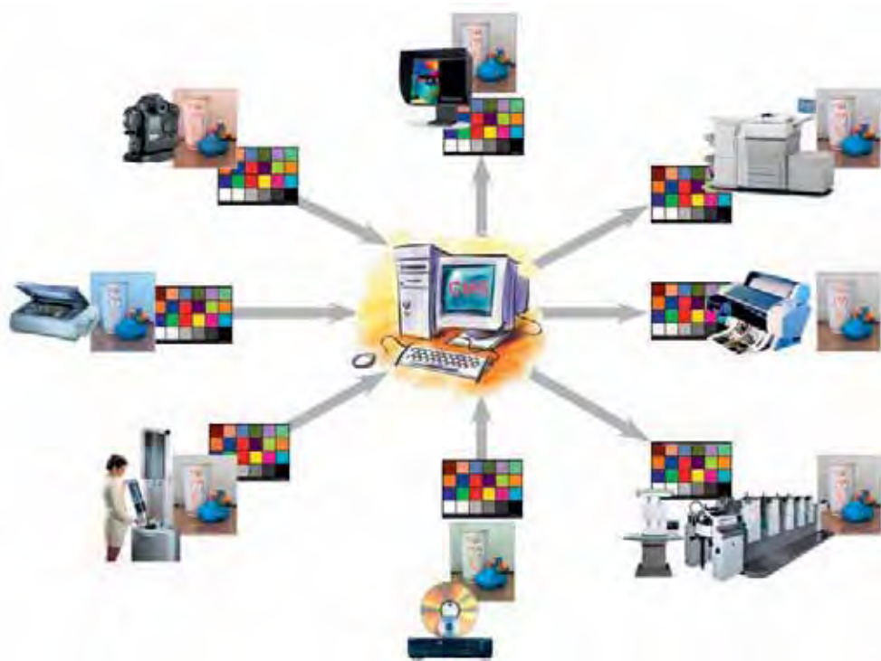
Slika 10.42 Sistem za upravljanje barv CMS deluje kot prevajalnik barvnih receptur med napravami in tehnologijami, da bi ostali barvni učinki čim bolj enaki; isti barvni učinek dobimo v različnih primerih s povsem različnimi barvnimi opisi RGB ali CMYK. To omogočajo barvni profili, s katerimi so opisane upodobitvene značilnosti naprav in tehnologij.
