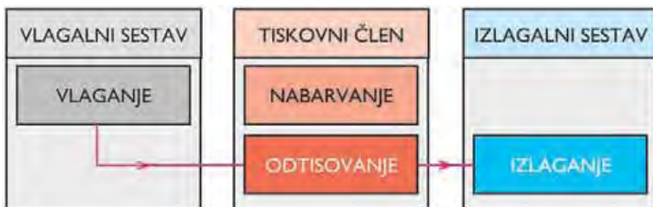
Slika 8.1 Tiskanje, blokovna shema tiskarskega stroja.
