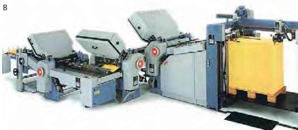
Slika 9.33 Kombinirani zgibalni stroj z noži in žepi (a). Stroj za križno zgibanje, ki ima samo žepe zavzema bistveno več prostora (b).
