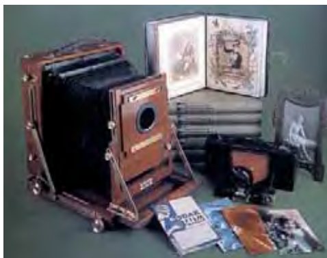
Slika 1.11 Fotografška tehnika in tehnologija iz obdobja okoli leta 1870 (mokri kolodijev postopek).
