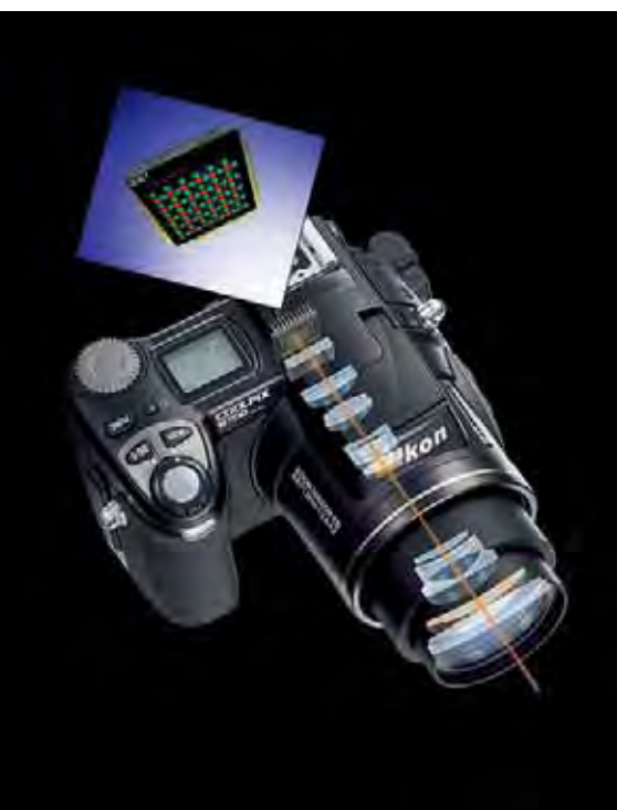
Slika 7.7 Digitalna fotografija deluje po enakih načelih kot človeški vid: objektiv namesto roženice (1), snemalno vezje namesto mrežnice s paličkami in čepki (2) ter slikovni procesor za »vizualno« obdelavo motiva namesto možganov (3)
