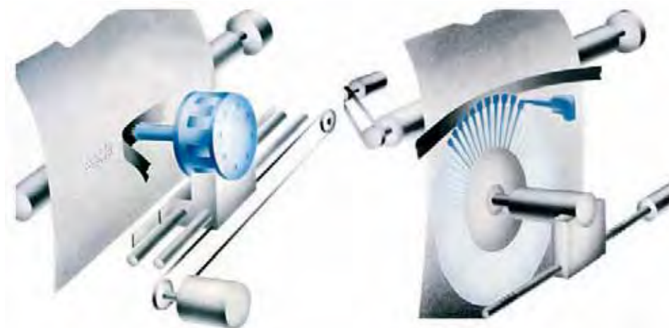
Slika 6.28 Delovanje matričnega in marjetičnega pisalnika temelji na udarjanju iglic oz. matric s črkami ob pisalni trak.
