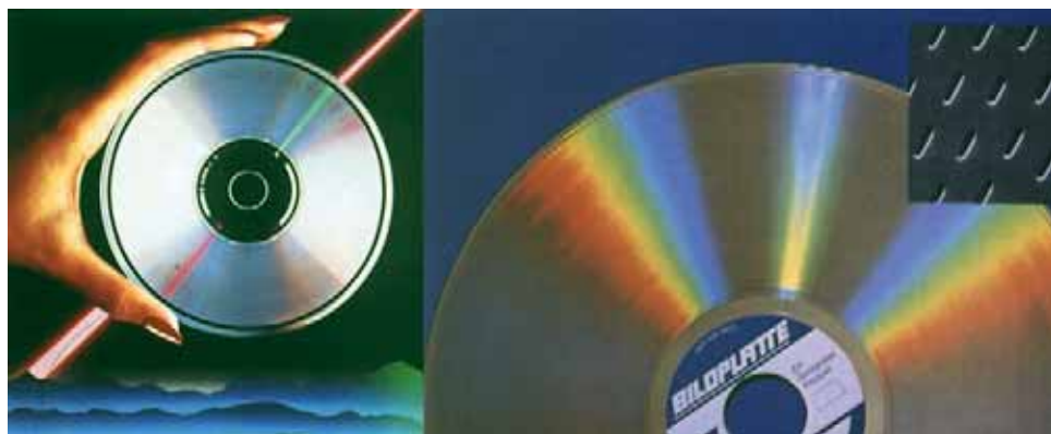
Slika 1.25 Laserska plošča, kompaktna plošča, slikovna plošča, zgoščenska, fotodisk, videodisk, vse to so imena za isti fizični izdelek različnega sporočilnega naboja, ki nosi vsem razumljivo oznako CD – compact disk. Na desni sliki je njena povečana površina.
