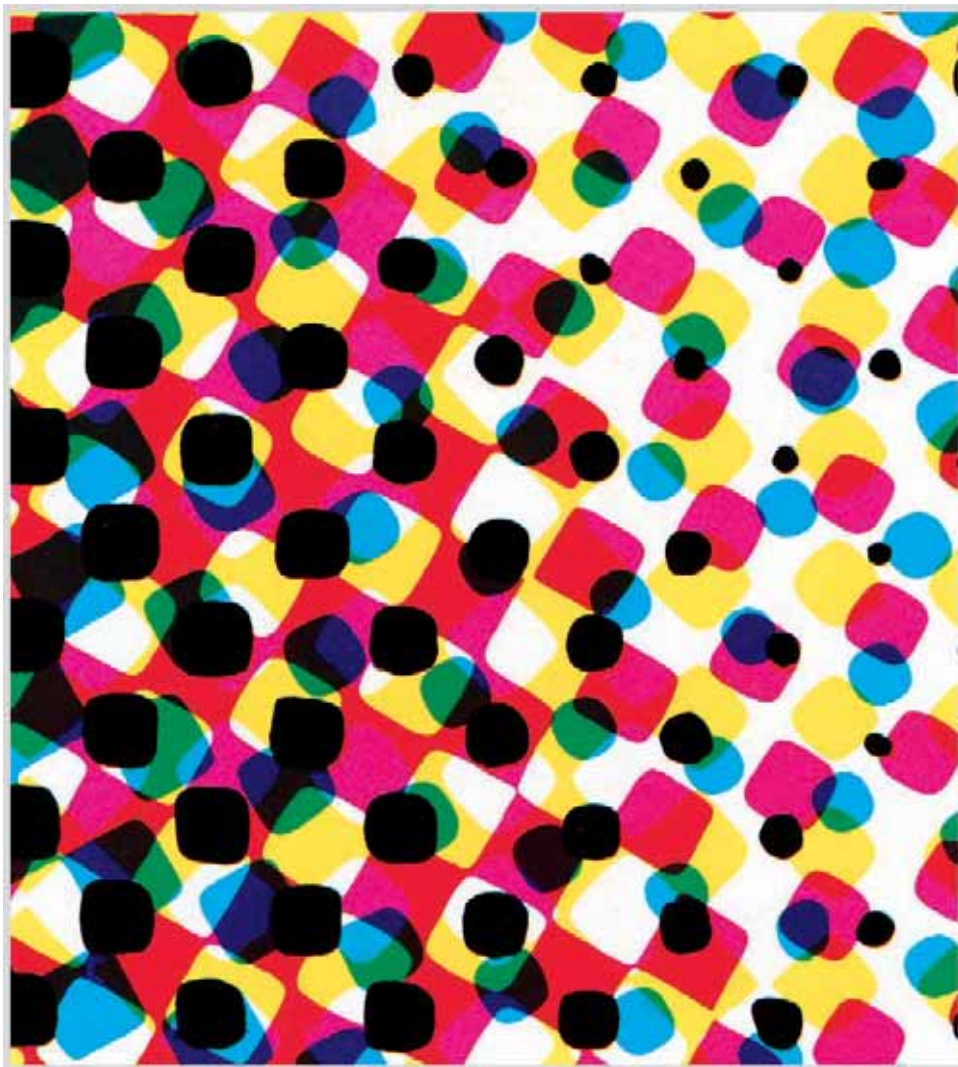
Slika 7.39 Povečava trikromatske avtotipijske reprodukcije.
