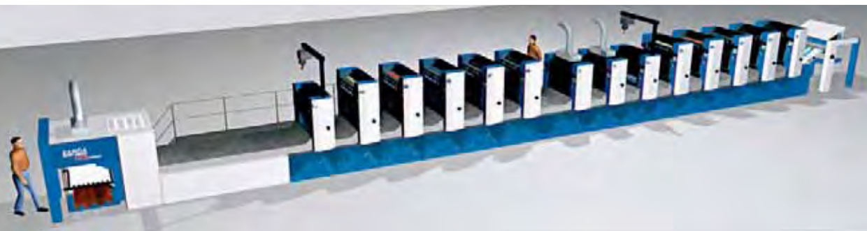
Slika 8.65 Desetbarvni ofsetni stroj za obojestranski tisk 5+5 z navadnimi in hibridnimi tiskarskimi barvami in z dodanimi členi (moduli) za obojestransko lakiranje z disperzijskimi in UV-laki, dvema vmesnima sušilnikoma z vročim zrakom in enim vmesnim UV-sušilnikom. Na koncu je še en lakirni člen, v izlagalniku pa moduli za sušenje z vročim zrakom in UV-sevanjem. Stroj je namenjen za tiskanje embalaže za modno, kozmetično in avtomobilsko industrijo, omogoča pa tudi lakiranje z zlatimi in srebrnimi laki, ob disperzijskih in UV-lakih pa tudi uporabo motnih in visokosijajnih lakov.
