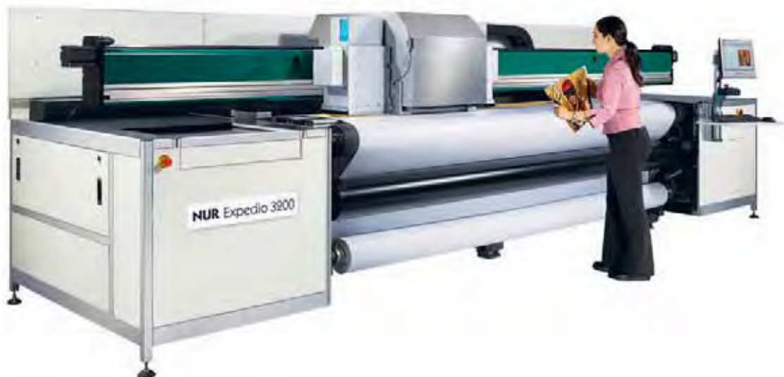
Slika 8.58 Širokoformatni kapljični stroj za tiskanje »jumbo« plakatov za panoje, zgradbe, vozila ipd.
