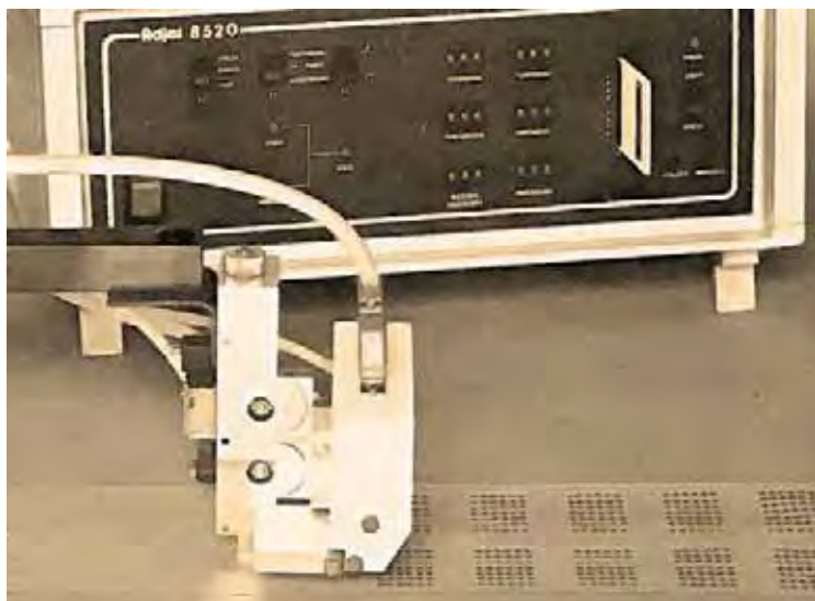
Slika 9.42_B Lokalno oziroma točkovno nanašanje lepila s kapljičnim tiskom je v sodobnih tehnologijah vse pogostejše.
