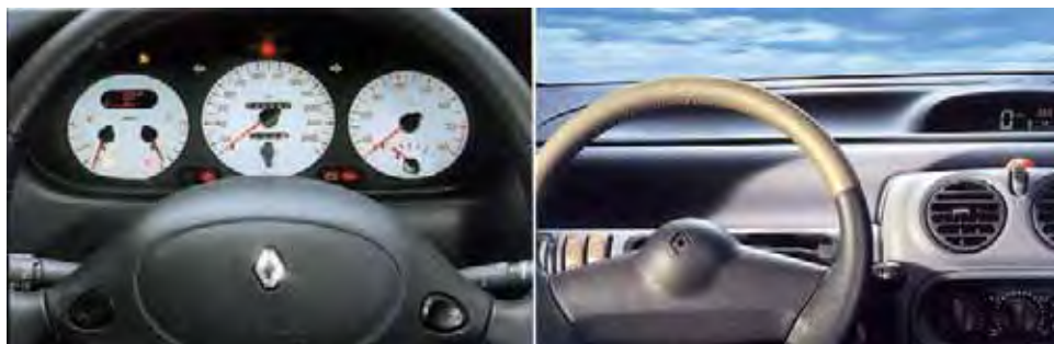
Slika 1.23 Športni avtomobili so večinoma opremljeni z analognim merilnikom hitrosti, eden prvih avtomobilov z digitalnim pa je bil Renault Twingo.
