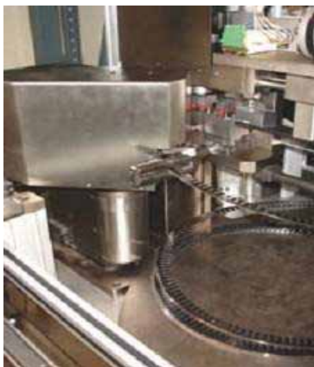
Slika 14: Oblikovanje jeklenih linij za rotacijsko izsekovalno orodje
