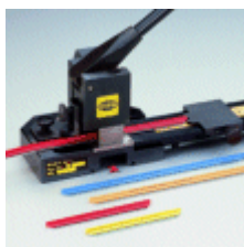
Slika 32: Rezanje žlebilne podloge na dolžino
