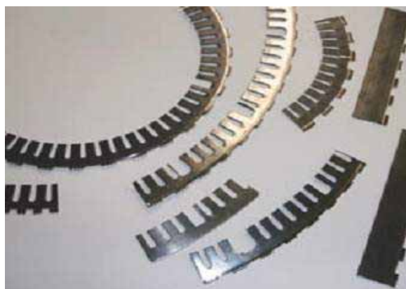
Slika 14: Oblikovanje jeklenih linij za rotacijsko izsekovalno orodje
