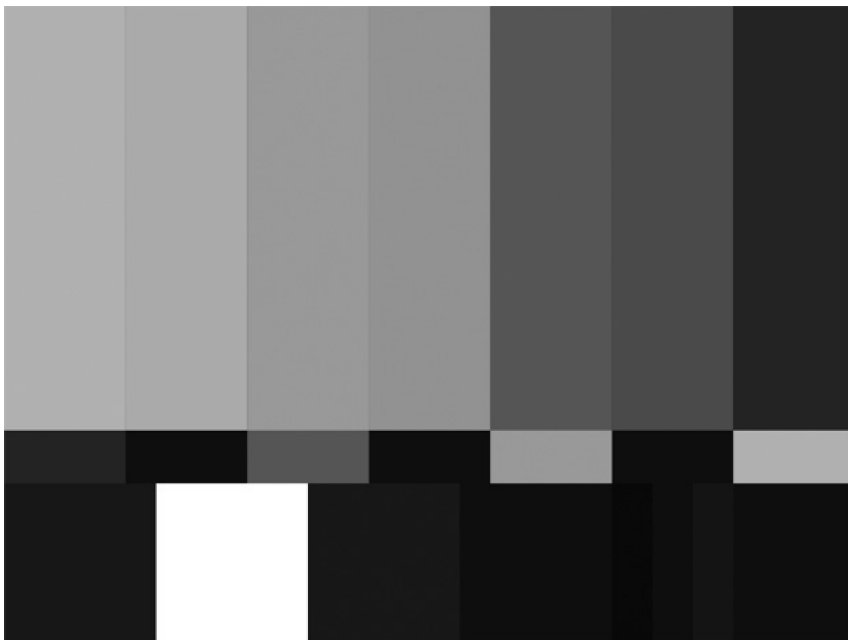
Slika 42: Testni videosignal PAL, kot ga ustvari večina profesionalnih kamkorderjev.
