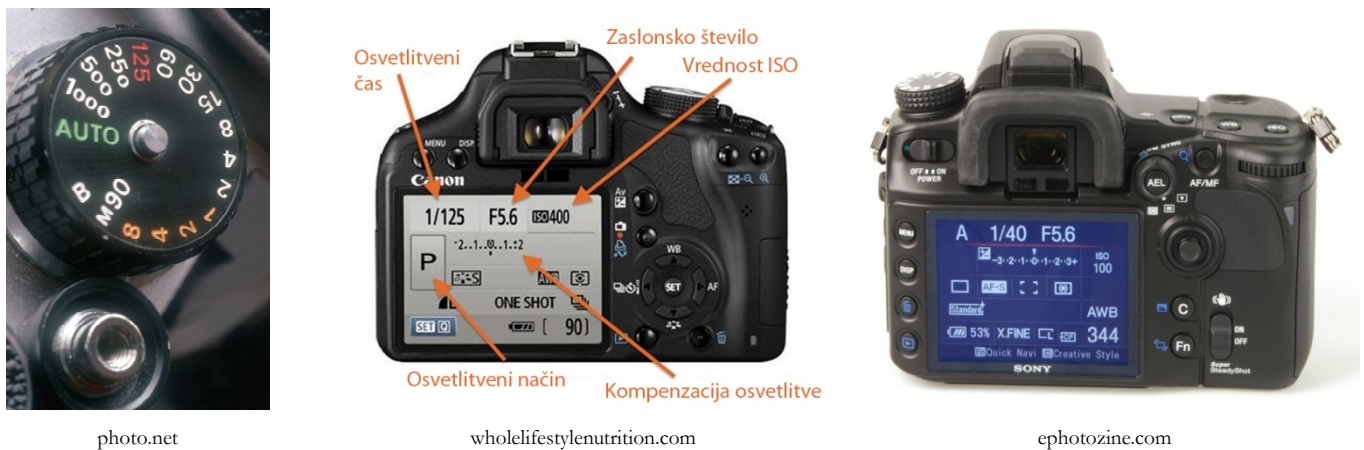
Slika 92 – Pri starejših elektromehanskih kamerah smo osvetlitveni čas nastavili s preklopnikom na vrhu ohišja (levo), medtem ko ga pri digitalnih kamerah nastavimo na zaslonu LCD (sredina, desno)
