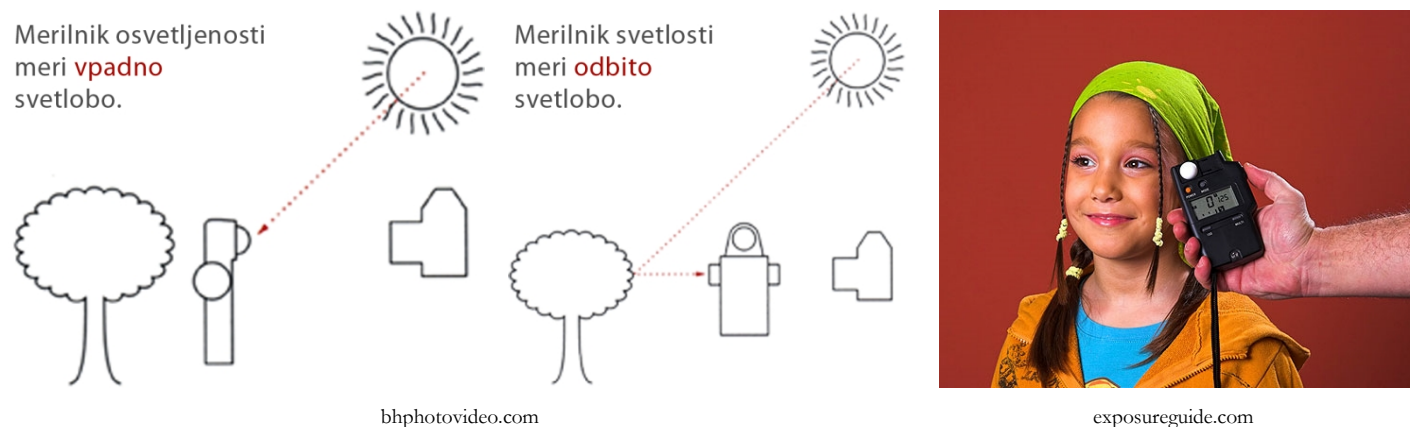
Slika 104 – Namesto da bi izmerili osvetljenost motiva (levo), s svetlometerom v kameri izmerimo njegovo svetlost (sredina), ročni merilnik osvetljenosti postavimo pred motiv in ga obrnemo v smeri kamere (desno)
