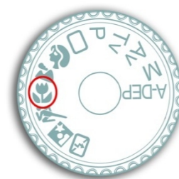
Slika 69 – Makrosnemalni način označuje stilizirana rožica (levo), izberemo ga v meniju kamere (Close up, sredina) ali s preklopnikom, če ga kamera ima (desno)
