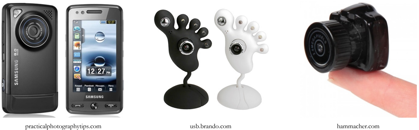
Slika 25 – H kameram z enostavnim iskalom prištevamo tudi digitalne kamere v mobilnih telefonih (eden od Samsungovih modelov, levo), bolj ali manj domiselno oblikovanje spletne kamere (USB Foot Web Cam, sredina) in miniaturne digitalne kamere (Hammacher Schlemmer, desno)
