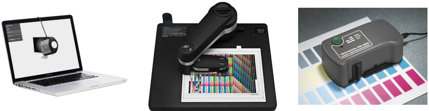
Slika 129 – Z barvnimi kalibratorji lahko izdelamo barvne opise naprav, namenjenih prikazu slik, in na ta način zagotovimo identičen prikaz barv na vseh napravah na poti do prikaza končne slike
